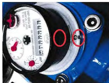
Bevor die Kunststoffhaube wieder montiert werden kann, muss sichergestellt werden, dass Nut(A) und Nut (B) in einer Linie übereinander positioniert sind
