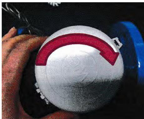
Haube nun mit dem Uhrzeigersinn bis zum Anschlag drehen und Inbus-Schraube festziehen
