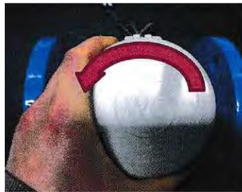
Die Kunststoffhaube gegen den Uhrzeigersinn bis zum Anschlag drehen
